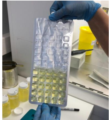
Sulgemata Quanti-Tray kott basseinivee prooviga. (Foto autor: Elis Kägo)
