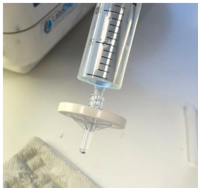
Spetsiaalne filter veeproovi filtreerimiseks. (Foto autor: Elis Kägo)
